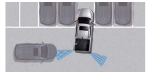
Radar ruchu poprzecznego z tyłu pojazdu (RCTA) Kiedy podczas cofania zostanie wykryte zbliżanie się samochodu z tyłu, po obu stronach pojazdu, RCTA włączy dźwiękowy sygnał alarmowy i uruchomi hamulce, aby zapobiec kolizji.
