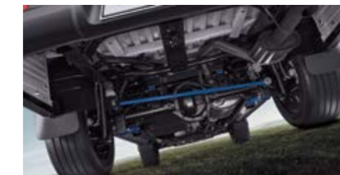
Wielowahaczowe zawieszenie niezależne
